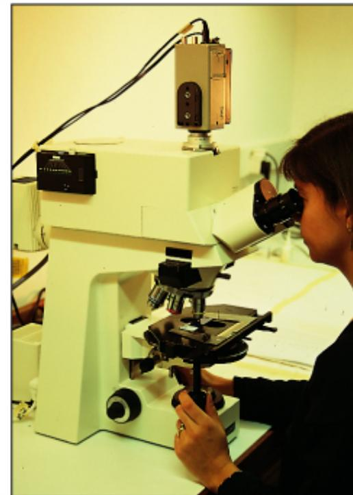
Il microscopio a contrasto di fase permette di osservare cellule e tessuti a fresco, senza bisogno di colorazioni, fornendo un'immagine dinamica, ottimale per lo studio di colture cellulare ma con grandi limiti riguardo lo studio dei dettagli.
