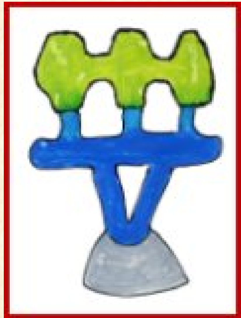
Fusione d'elementi per ceramica. Modellazione in cera con scarichi e senza
